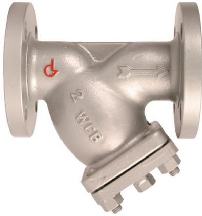
**Werkstoffe:** Gehäuse: Stahlguss A216 WCB, Sieb: Edelstahl 1.4301, Deckeldichtung PTFE (1/2"-1-1/2"), Graphit mit Spießblecheinlage (2"-12")
