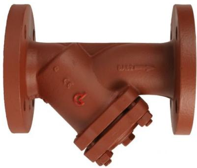
**Werkstoffe:** Gehäuse: Sphäroguss GGG 40 (JS 1030), Sieb: Edelstahl 1.4301 (ab DN 150 Lochblech 1.4301), Deckeldichtung Graphit mit Spießblecheinlage
